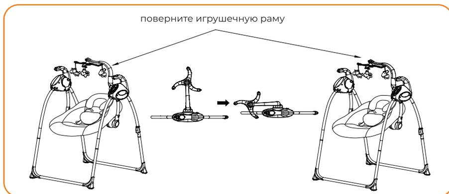
8. Складывание: нажмите кнопку складывания, сложите сиденье и зафиксируйте его с помощью кнопки-защелки, затем сложите трубку внутрь.
