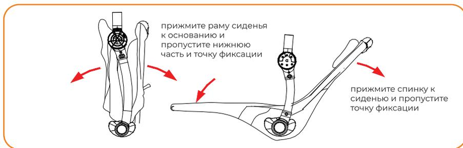
4. Как показано на следующем рисунке, вставьте левое и правое основания труб в металлическую ось, направьте на круглое и плоское место на металлической оси для сборки.
